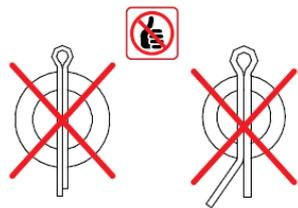
为了确保发挥其固定销轴的功能，此类型的开口销在安装时必须将两个尾片打开，而不是仅打开较长的尾片
