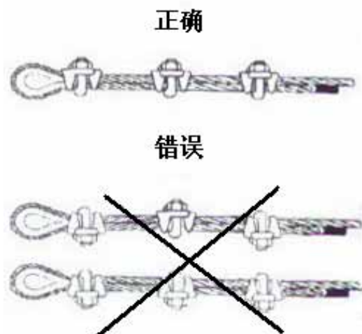
图 10-5 钢丝绳夹的正确布置方法
